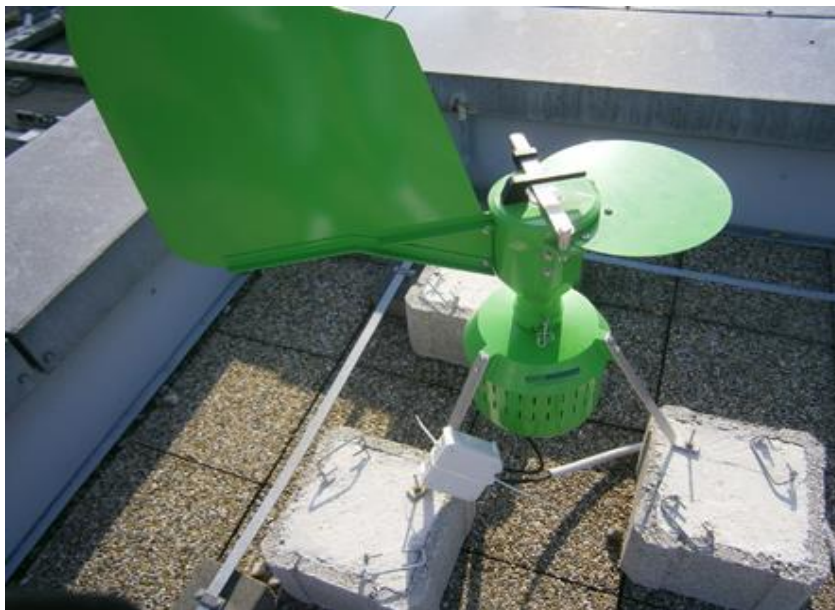
Slika 1. Uzorkivač peludi tipa Hirst proizvođača Burkard
